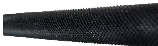
菱目ローレット加工(ステップ表面)
