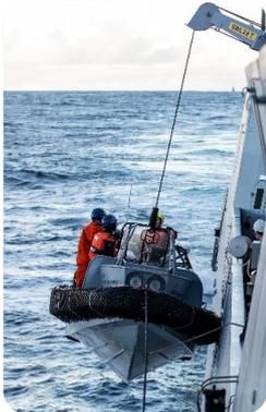
ヘンリクセン社のオフロード・リリースフックは搭載艇の揚降に最適なフックシステムです。ボート揚降中の意図しないフックのリリースを防ぎ、風浪やうねりがある海域で安全に搭載艇を進水できます。
