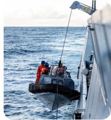
オフロード・リリースフックは 1 点吊りの総重量 15 トンまでのボートに取付けて使用します。
