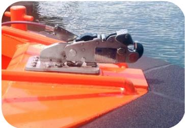
ペインターフックは搭載艇の進水 / 揚収時にペインターライン（曳航索）でテンションをかけて縦揺れ（ピッチング）と横揺れ（ローリング）を制御します。リモコンハンドル操作でペインターラインをリリースできます。I. H. S. システム（オプション）と併用することで、メインフックの操作前にペインターフックが誤って操作されることを防ぎます。
