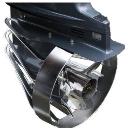
プロペラガードは水難救助活動で懸念される、プロペラへの巻き込み事故や、プロペラの損傷を防ぎます。運用条件に合わせて、ポリプロピレン製、ステンレス製を選択可能です。各メーカーの船外機に取付可能です。※ プロペラは既存の物を使用できます。取付にはドリル等でキャビテーションプレートへの穴あけが必要です。
