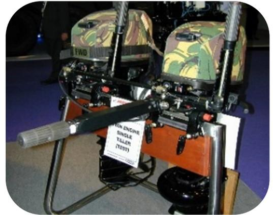
FAST PIRS Engine GEN II は、バラス社（英国）がマリナー社の 2 ストローク船外機をミリタリー仕様に改造した水没後リスタート機能付きの特注船外機です。
